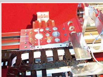
Beim Bau von Antrieben für den Einsatz im Vakuum bestehen wesentliche Unterschiede zu sonstigen Anlagen. Die physikalischen Bedingungen erfordern eine spezielle Auslegung und Konstruktion sämtlicher fester und bewegter Komponenten.
