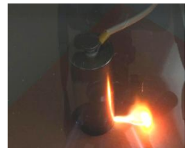
Durchschlag bei 50kV
